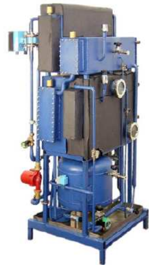
Sonnenklima (10 kW Kälte )
